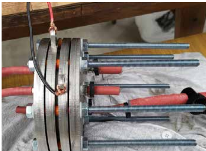
Rys. 6. Model badawczy elektrolizera Pomiarów dokonywano w 3 seriach dla temperatur 27, 31 i 38°C przy natężeniu prądu 0,5; 1; 2; 3; 4; 5; 7; 10; 15A. Odczytywano wartość napięcia, która z kolei posłużyła do
